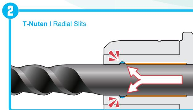
**reduzieren die Gefahr des Fräserauszugs und halten die Spannfächentrecken.**
