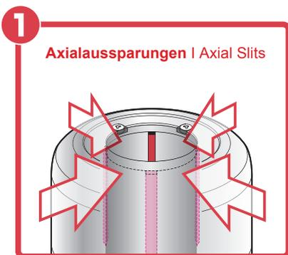
**erhöhen die Spannkraft**
