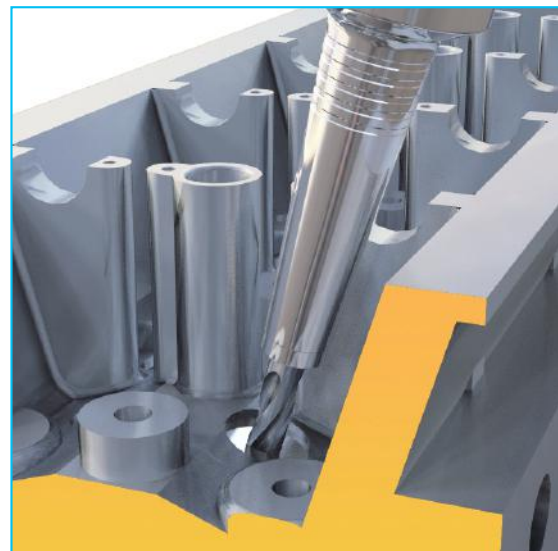
Bohren in engen Bearbeitungsräumen Drilling in tight space
